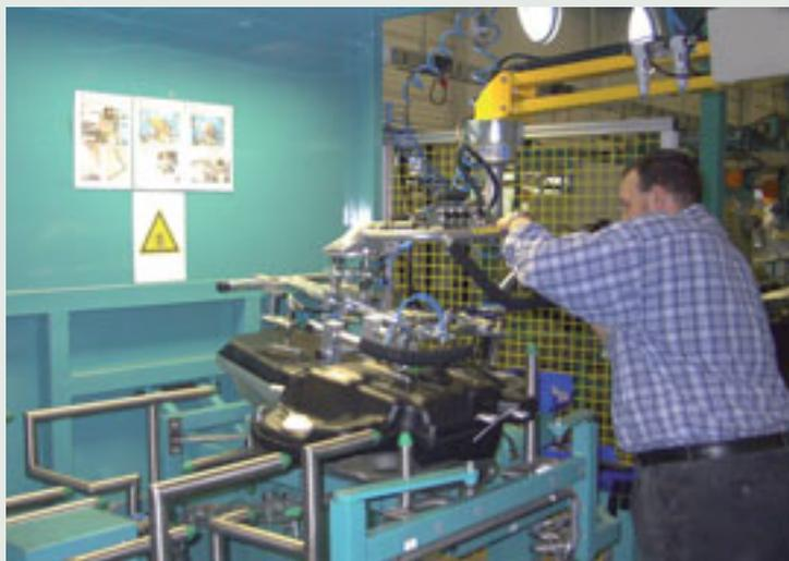
Manipulator mit Schwenkarm für Handhabung von Autotanks
