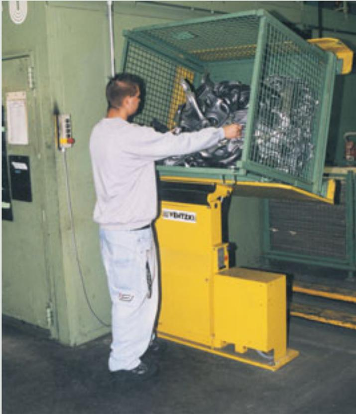
NHE 350 - Entnahme der Teile in oberster Hubstellung, für individuelle Körpergrößen einstellbar
