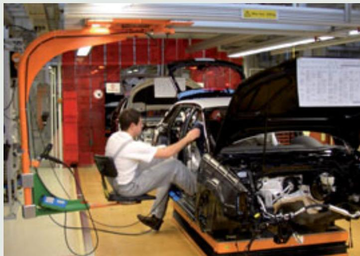
Einbauhilfe mit Ergo-Sitz für Montage von PKW-Komponenten
