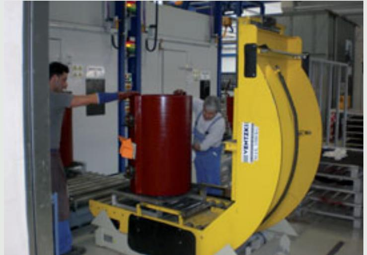
Kippstation für Transformatoren, mit Rollenbahn und Zentrierprisma
