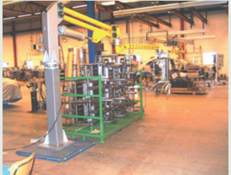
Knickarm-Säulenschwenkkran kombiniert mit Hublifter Typ VLIR (siehe Seite 44) und einem Vakuum-Lastaufnahmemittel
