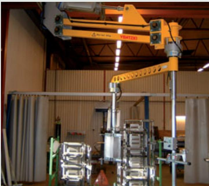
Projektbeispiel Manipulator Typ VSPA mit Bremsen für die horizontalen und vertikale Achse
