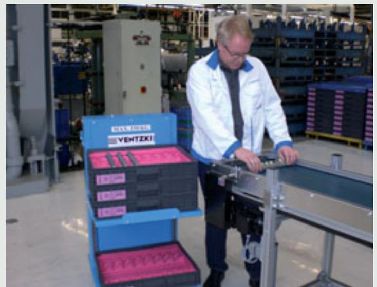
Vierrädrige Ausführung für Sonder-Ladungsträger, mit Schubbügel in Sonderlackierung
