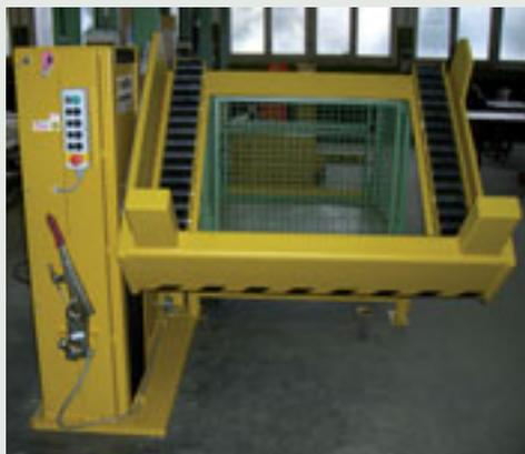
HNE 1500-S mit Rollenbahn (2-teilig) mit entriegelbarem Anschlag für Gitterbox
