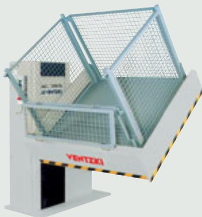
Vorderwand der Gitterbox im geneigten Zustand abklappbar
