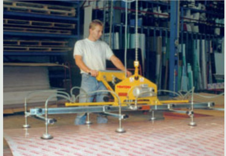
Das VENTZKI- Vakuum-Hebegerät VVH bewegt Platten aus unterschiedlichsten Materialien und Werkstoffen. Ob robuste Bleche oder empfindliche Scheiben – das Vakuum-Hebegerät VVH packt sicher und schonend. Bei horizontalem Transport bis 2 t, bei Schwenken um 90° bis 1 t möglich (Preis auf Anfrage).
