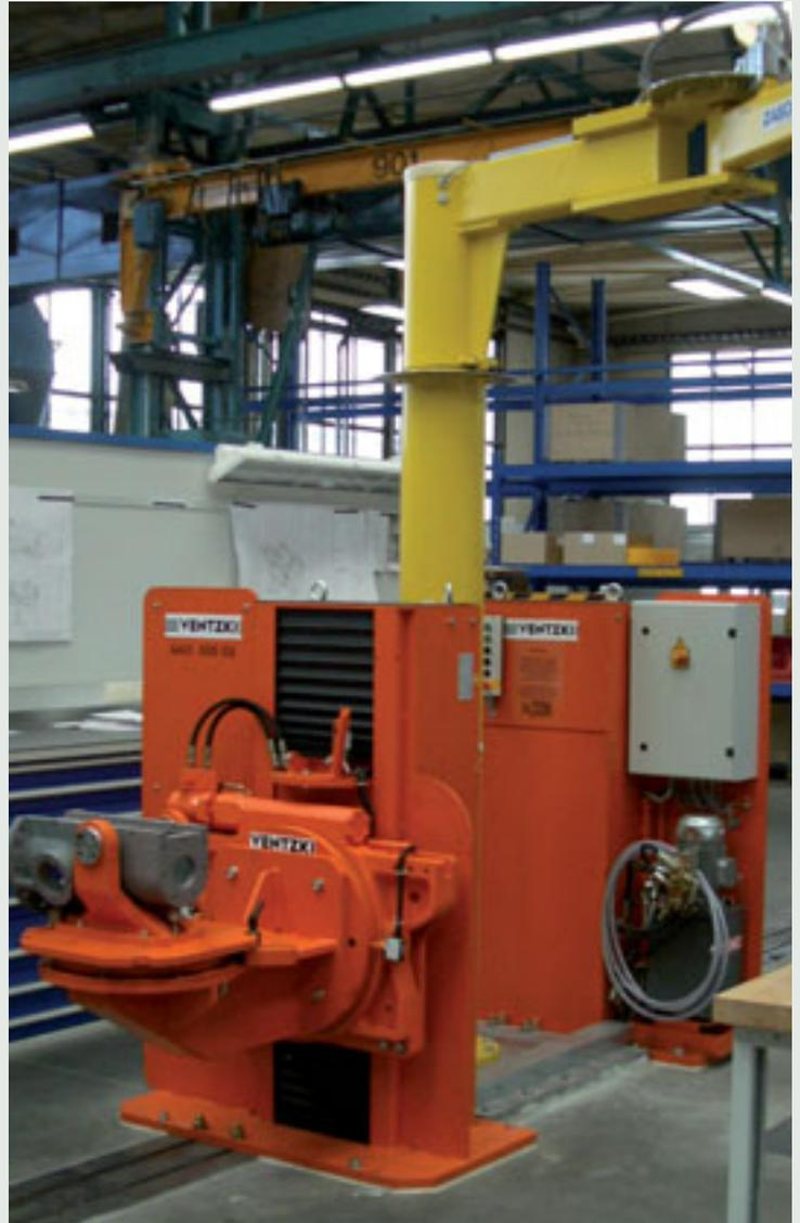
Mehrachsiges Hub-/Wende- und Drehgerät HNE 600-S zur Getriebemontage
